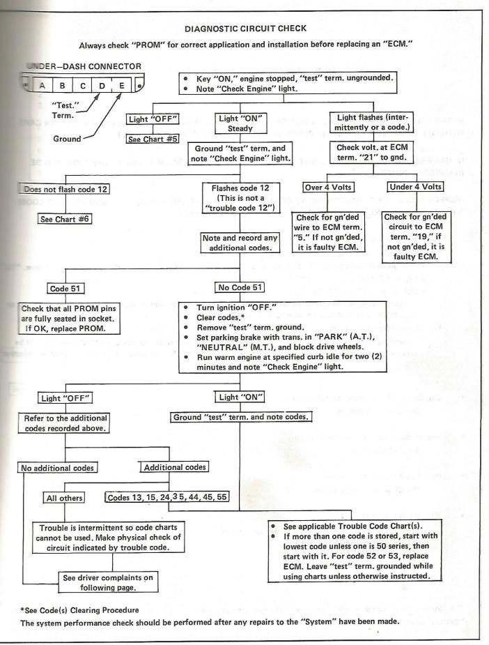
Fig. 6E1-14--Diagnostic Circuit Check
