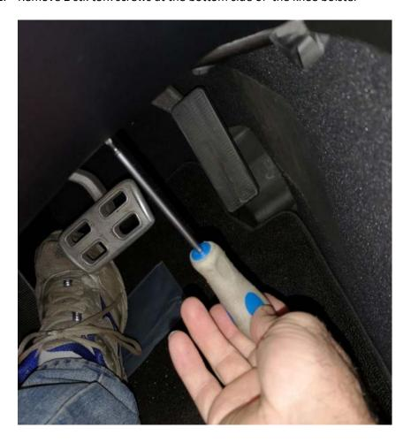
3. Remove torx on left side av tenningsnøkkel (behind cover of the cabin temp sensor)
